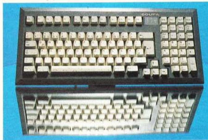
Der Golf besitzt eine der besten Tastaturen für tragbare Computer. Trotz des kompakten Layouts verwendet sie, wie eine MF2-Tastatur anderer ATs, 102 Tasten.
